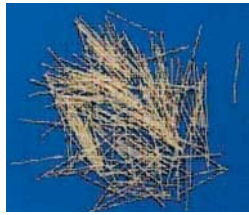
■本工事に用いられた ビニロン短繊維 (繊維長30mm)
