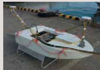
写真-2 曳航体センサー部
