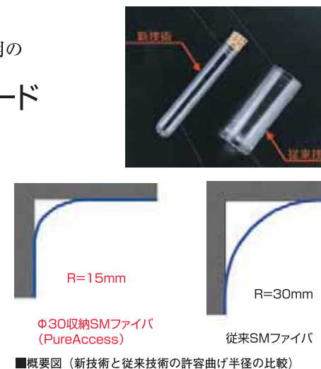
■概要図(新技術と従来技術の許容曲げ半径の比較)
