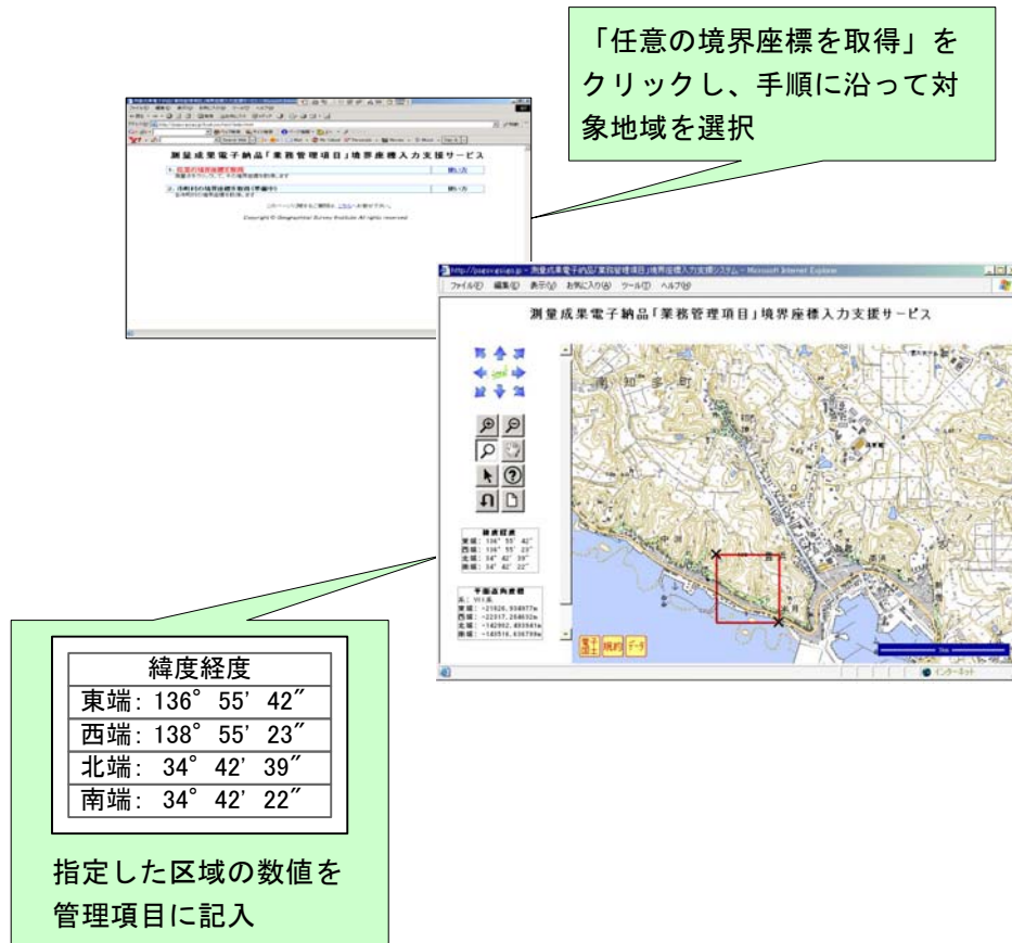
図 9-4 測量成果電子納品「業務管理項目」境界座標入力支援サービス
