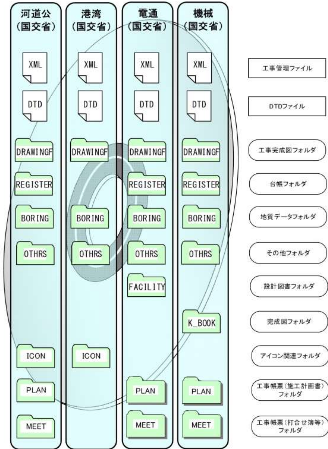
図 2-3 電子媒体に格納される電子成果品及び工事帳票のイメージ (国交省)
