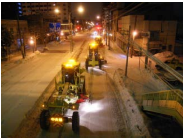
市街地における機械除雪（除雪グレーダ）
