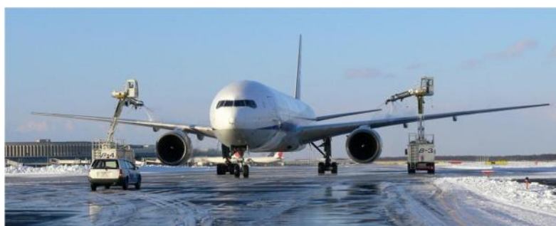
空港における雪氷除去作業
