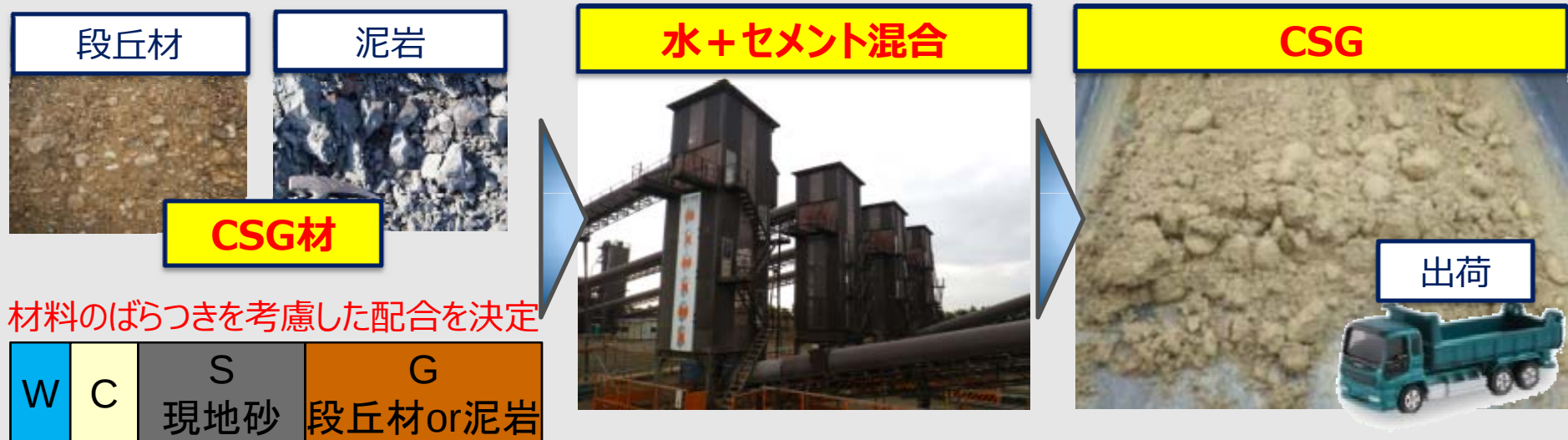
図 CSG材料構成
