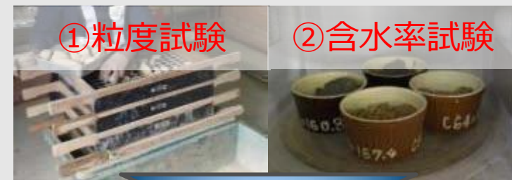
現状のCSG材日常管理試験方法(1回/時間)
