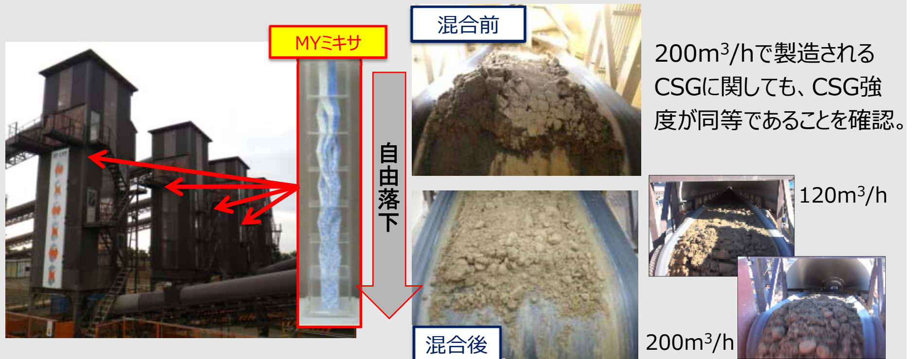
写真 連続式CSG混合設備「M-Yミキサ」
