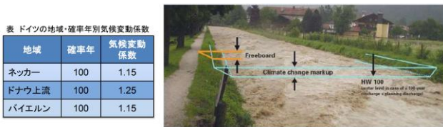
図-17 ドイツの気候変動に対応した施設設計事例 出典: KLIWA 'Climate Change in Southern Germany Extent - Consequences - Strategies, pp.18-19, 2009. *KLIWA:水資源管理に係る気候変動と影響に対応するためのドイツのバーデン=ビュルテンベルク、バイエルン、ラインラント=プファルツの各州とドイツ気象庁を含む協同プロジェクト。
