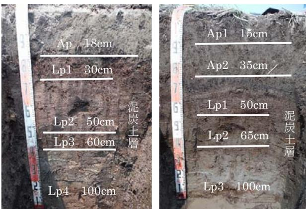
写真-5 A圃場の施工前土壌断面
