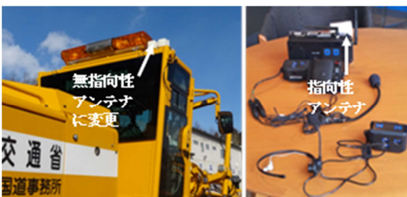
写真-12 通信装置のアンテナ変更
