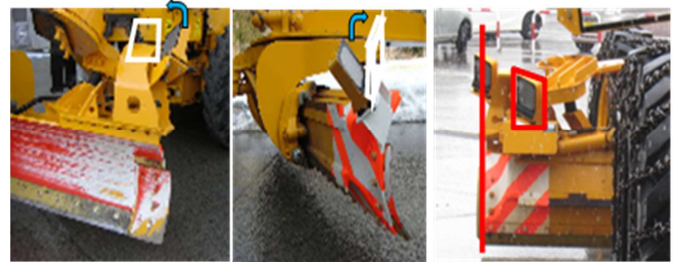
写真-13 ブレードマーカースの取付位置変更
