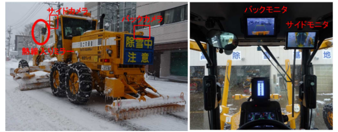
写真-3 死角確認のためのモニター等の配置状況
