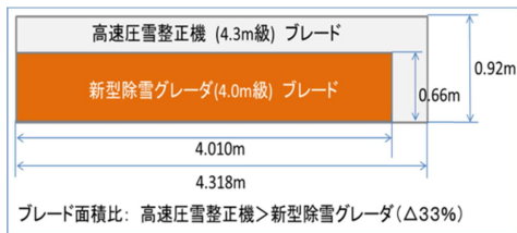
図-6 ブレードの寸法
