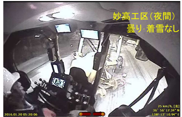
写真-6 運転室内の結露状況 (新型除雪グレーダ)
