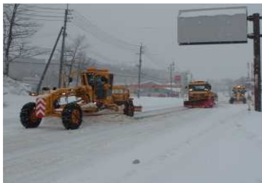
写真-1 新型除雪グレーダの現地調査・検証状況（先頭車両）
