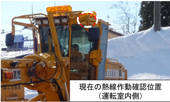
写真-10 運転室熱線ガラスの作動確認位置
