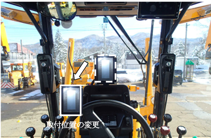
写真-11 ブレード押し付け力表示装置の位置変更
