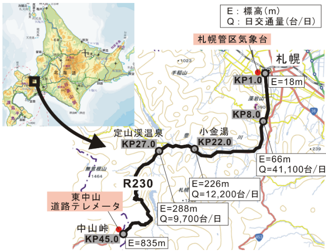
図4 実道での路面温度・気温測定概要
