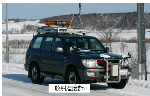
写真1 計測 TM 作成のための走行試験の様子
