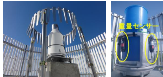
図6 重量式降水量計の外観(左)と貯留バケツの様子(右)
