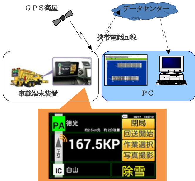
図1 車両位置情報システム概要
