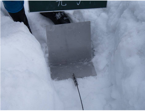
図 15 積雪後のそり設置例
