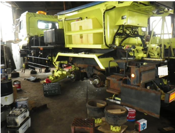
写真-2 定期整備実施状況(凍結防止剤散布車)
