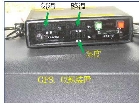
図2 観測装置の搭載状況
