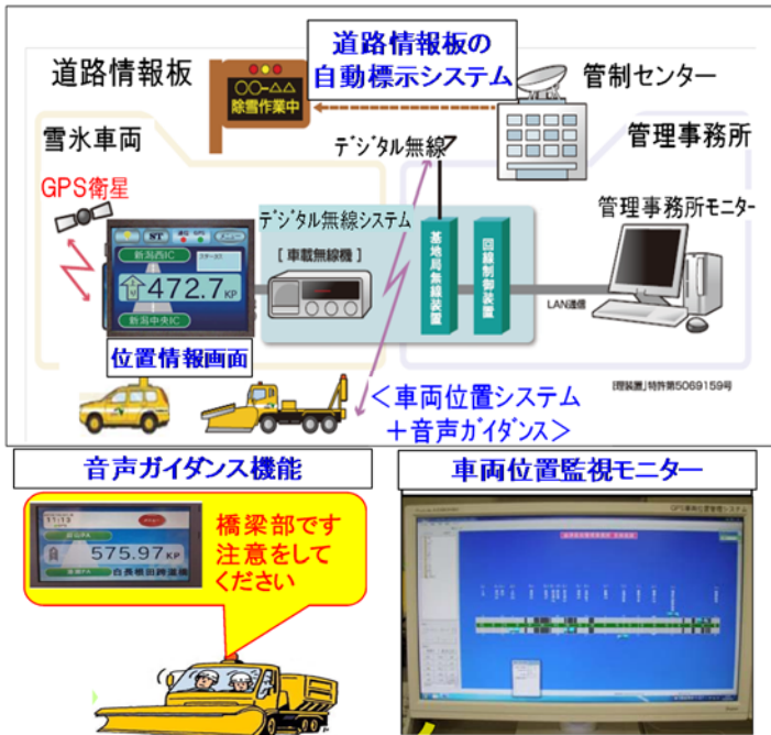
図2 除雪オペレーターアシストシステムの概要
