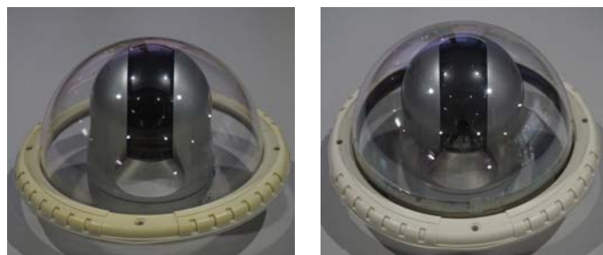
(A) 成膜無 (B) 成膜有 写真-2 WEBカメラカバーへの成膜の有無
