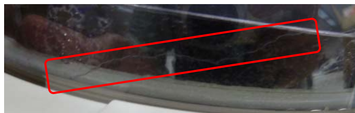
写真-4 導電膜のクラック状況
