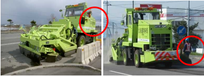
写真-8 施工中のブラシ確認状況
