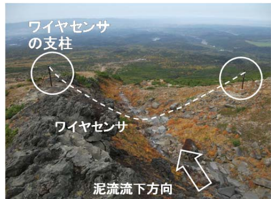
写真-2 現在最も多く利用されている泥流検知用ワイヤセンサ(十勝岳山麓)
