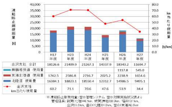
図1 北陸地区の凍結防止剤散布状況
