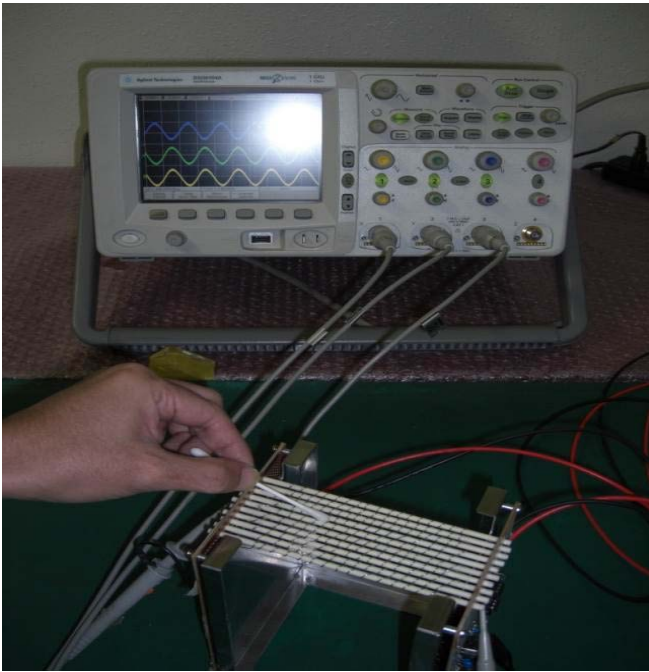
図 2 水分検知センサの検知試験・検証
