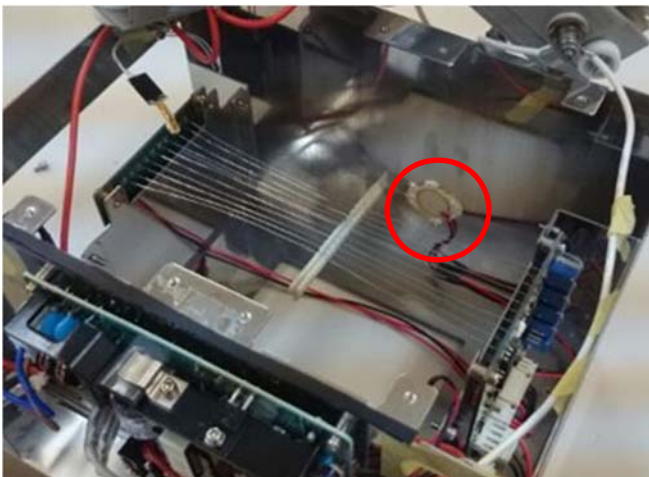
図 3 振動・音検知としてスピーカを取付け
