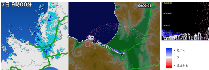
図12. WITHレーダー観測事例（12月7日9時：速度観測）
