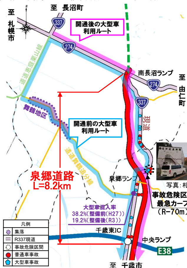
【当該区間周辺の危険箇所及び大型車の利用ルート】
