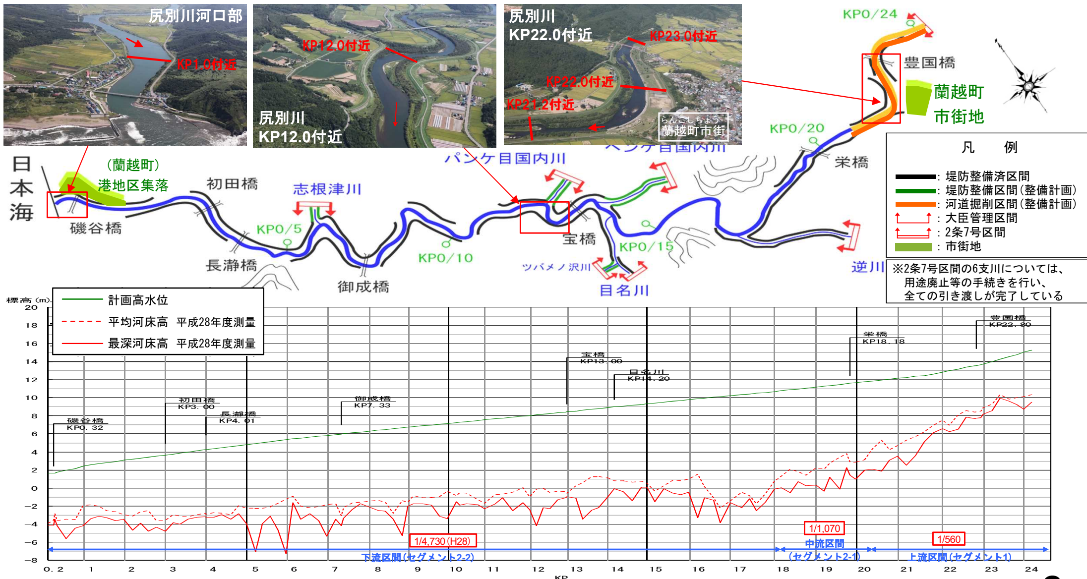
図1-2 平面図・河床勾配縦断図 (0.0km～24.2km)
