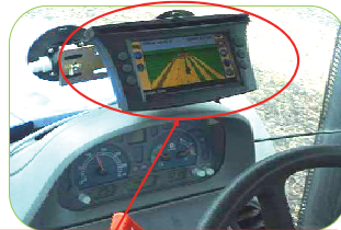
トラクター内のGPSガイダンスのモニター ・ほ場条件、作業パターンを入力すると作業経路を表示
