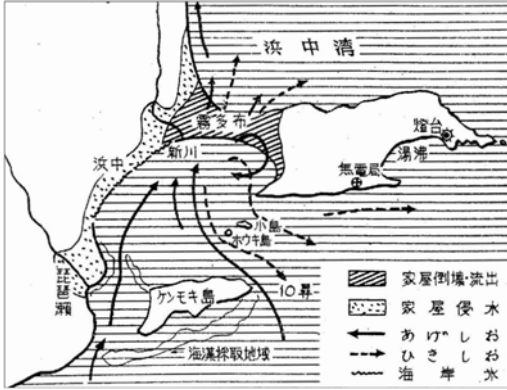
霧多布地区における津波による被害状況
