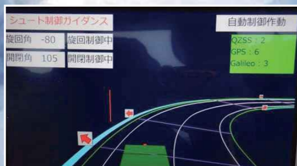
除雪現場の生産性向上の取組(準天頂衛星を活用した除雪作業の自動化)
