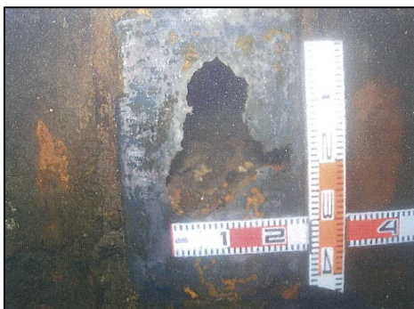
対策効果例(矢板が腐食した係留施設を改良し、安全な利用を確保)
