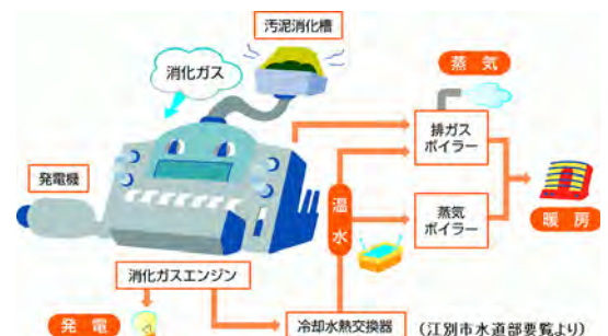
下水汚泥消化ガス発電イメージ (江別市水道部要覧より)
