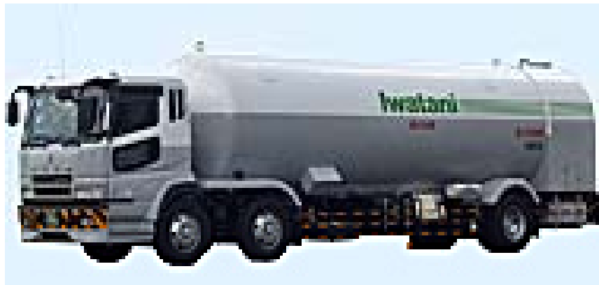
液水トレーラー：40,000L (32,000Nm 3 )以上 液化水素タンクローリー：23,000L (18,000Nm 3 )
