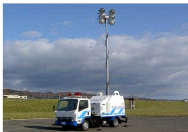
全 景（照明ポール伸長時）
