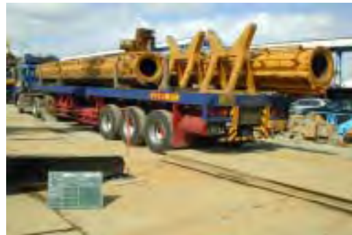
機材搬出（グラベルドレン施工機）
