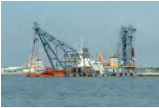
ポンプ浚渫船
