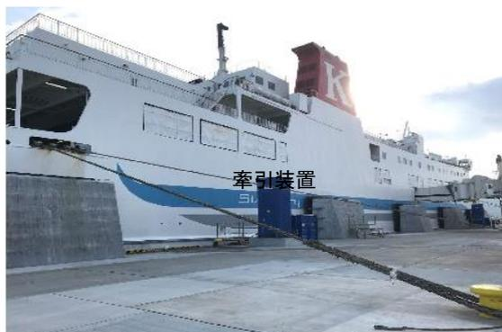
宮古港で導入されている自動係留装置(ロープ牽引を自動化)
