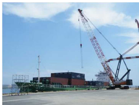
クローラークレーンをチャーターしてのコンテナ荷役
