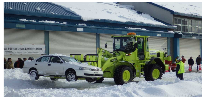
放置車両・立ち往生車両の移動状況（訓練）
