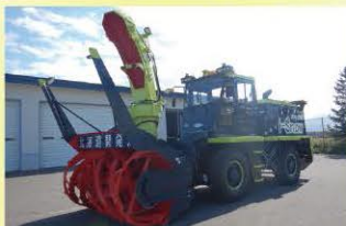
▲『除雪装置自動制御型』ロータリ除雪車 国道334号知床峠（網走側）に配備
