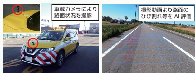
図23 AIを活用した舗装点検・診断
