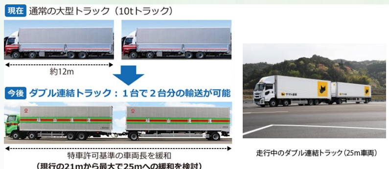
図19 ダブル連結トラックの概要 (出典:国土交通省道路局 HP)
