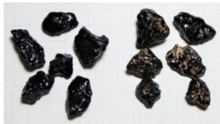
はく離しやすい6号砕石を用いた静的剥離試験の一例 左：HRバインダーECO-W、右：ポリマー改質アスファルトⅡ型
