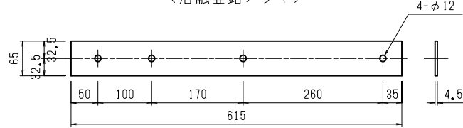
脚詳細図 (溶融亜鉛メッキ) S=1:10
