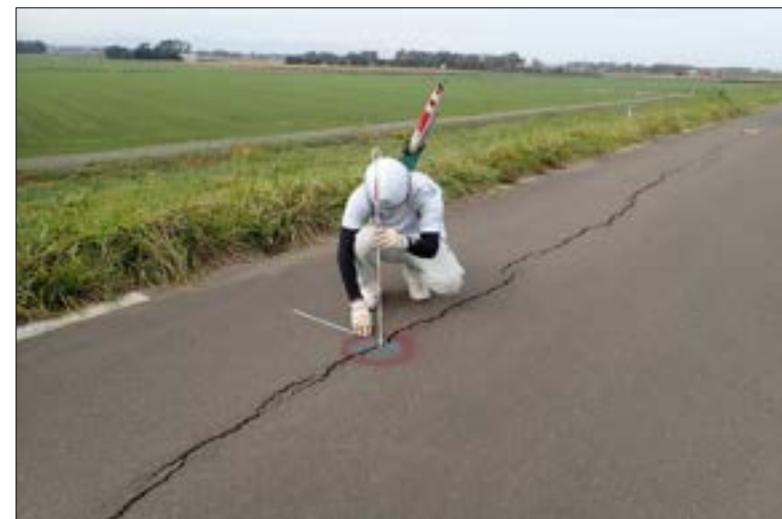
天端舗装の亀裂の計測状況
