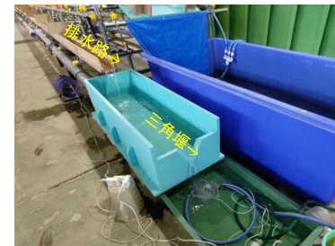
写真: 三角堰による流出量の計測
