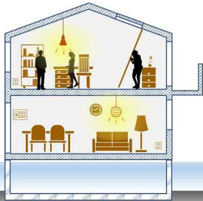
基礎による嵩上げ（高床化）
