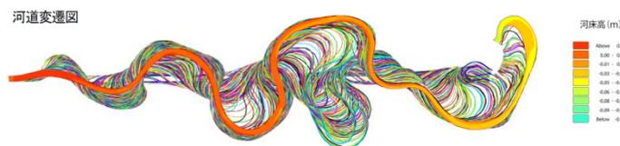
移動適合座標による流路変動と流れ場の計算例
