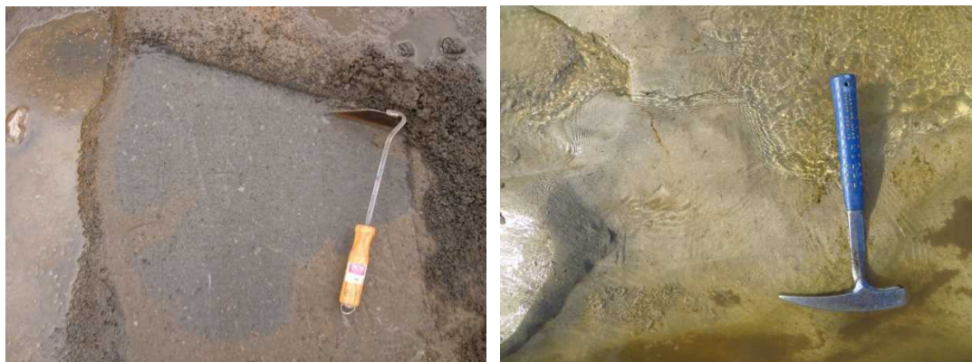
図 2.2 試験箇所は水際（左）もしくは水中（右）を選択する
