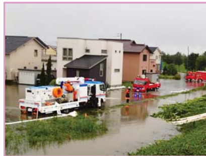
排水ポンプ車 緊急排水作業(音更町)
