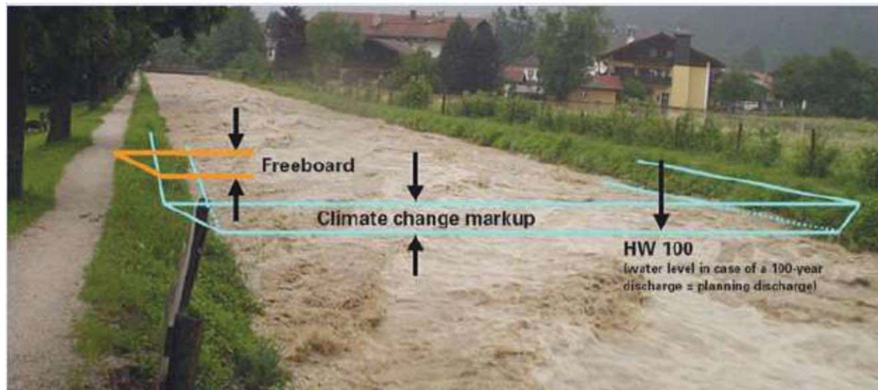
図 100年確率洪水位及び気候変動による水位上昇見込み量概念図 ※「Freeboard」は波・風等による水位上昇による越流を防止するためのもの
