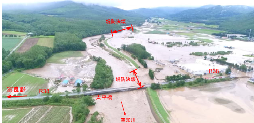
●札内川(帯広市 大正橋下流付近) 堤防決壊状況
