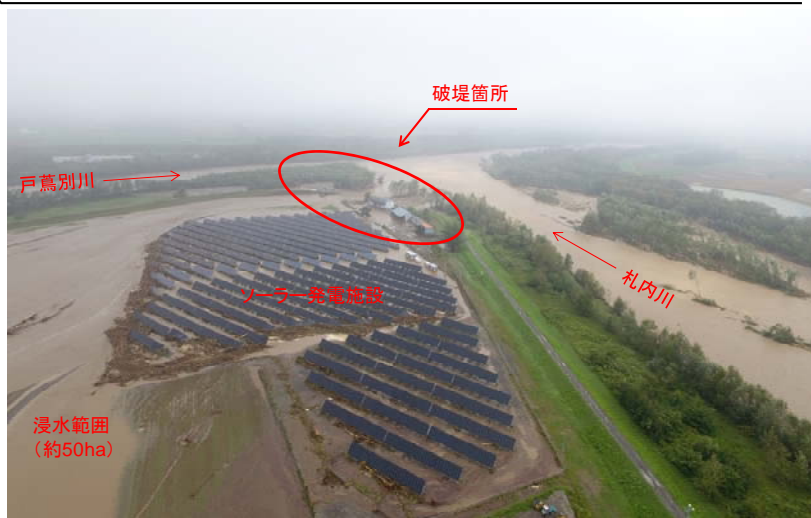
●札内川(帯広市 大正橋下流付近) 堤防決壊状況
