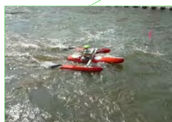
水面下の流速・河床高を計測する装置 (航ワイヤー式ADCP観測船)
