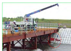
掃流砂を採取する装置 (土研式掃流砂採取器)
