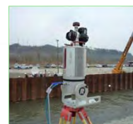
河床や氾濫域の形状を計測する装置 (マルチレーザースキャン)
