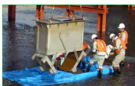
掃流砂を採取する装置 (バケツ式掃流砂採取器)
