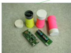
破壊実験において堤防の崩壊状況を計測する装置 (加速度センサー)
