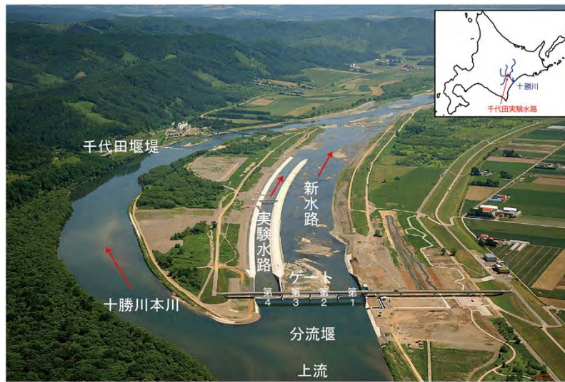
図1 千代田新水路の施設配置
