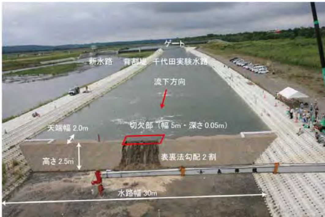
写真- 19 予備実験（正面越流）の状況
