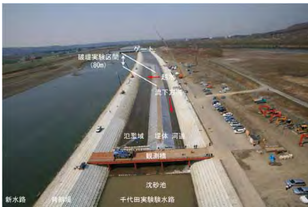
写真- 21 予備実験（横越流）の状況
